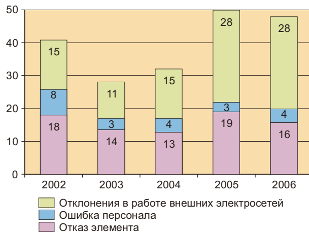
Рис. 2.1.3-2. Распределение нарушений в работе ИЯУ России по непосредственным причинам нарушений по годам
