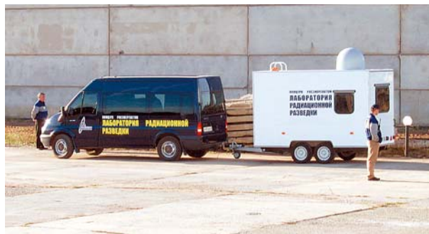
Рис. 1.3.2-1. Мобильная лаборатория радиационной разведки
