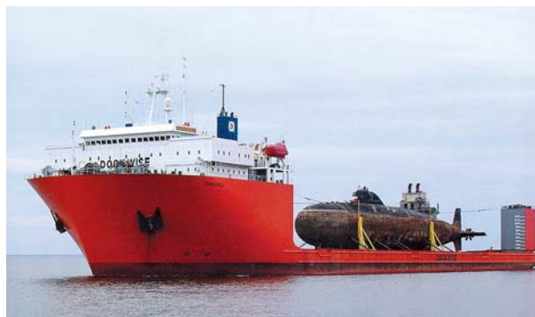
Рис. 2.1.4-1. Транспортировка АПЛ с использованием полупогружного судна
