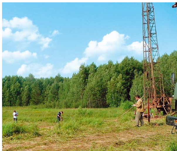
Рис. 5-5. Проведение опытно-фильтрационных работ на площадке ОАО «КЧХК»
