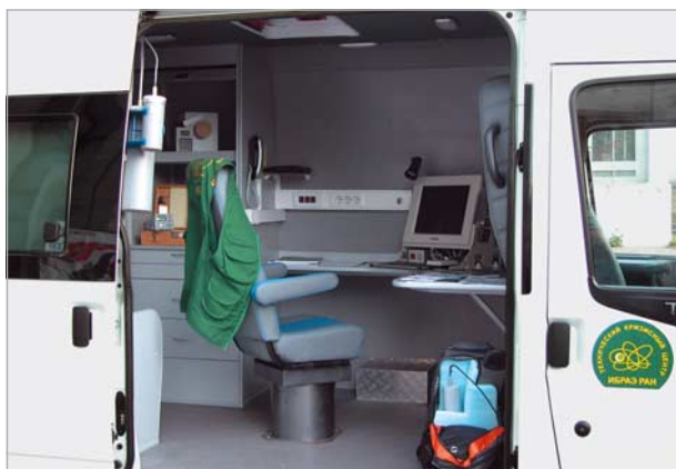
Рис. 2.5-4. Учения на Балаковской АЭС. Мобильная дозиметрическая лаборатория
