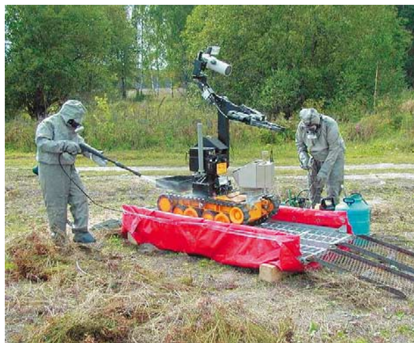
Рис. 2.5-1. Дезактивация робототехнического комплекса в полевых условиях
