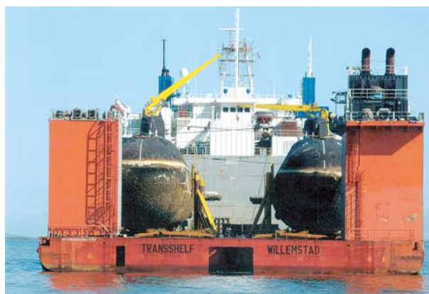
Рис. 6.2-1. Транспортировка двух АПЛ на одном судне-перевозчике
