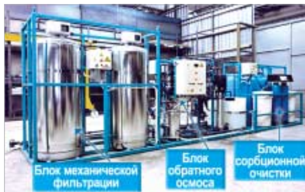
Рисунок 2.2-2 — Внешний вид стендовой установки очистки НАО
